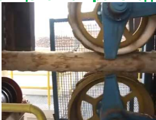
Окорка на линии Vitech Engineering
