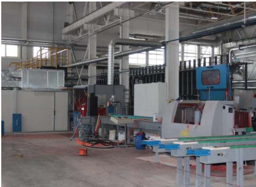
Линия для пропитки и выполнения отделочных работ на брусе Sarmax
