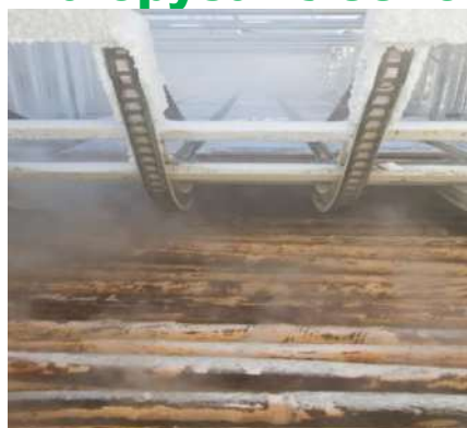
Гидротермическая обработка на линии Vitech Engineering
