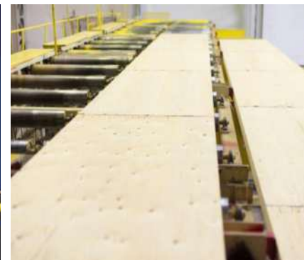
Раскрой плит ЛВЛ бруса в размер по заказу
