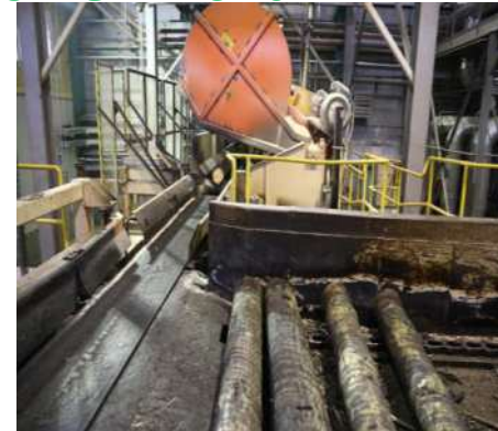
Распиловка кряжа на чурaki
