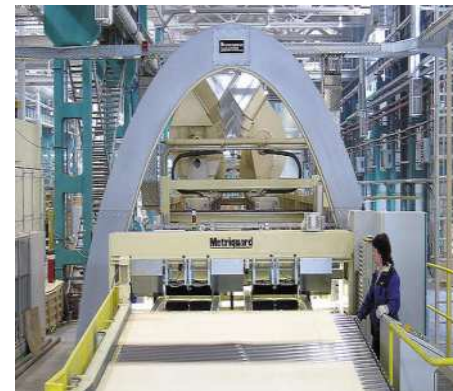
Определение плотности сухого шпона
