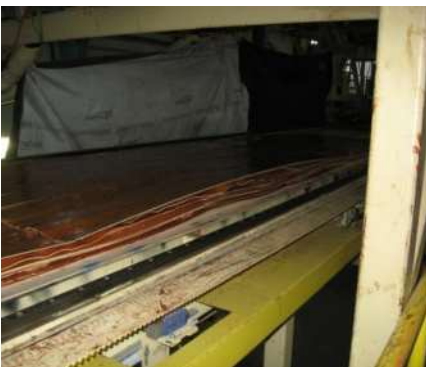
Нанесение клеевого состава
