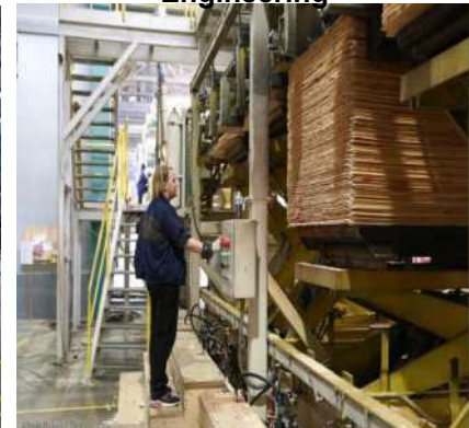
Сортировка листов шпона по прочности
